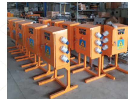
TỦ THI CÔNG
